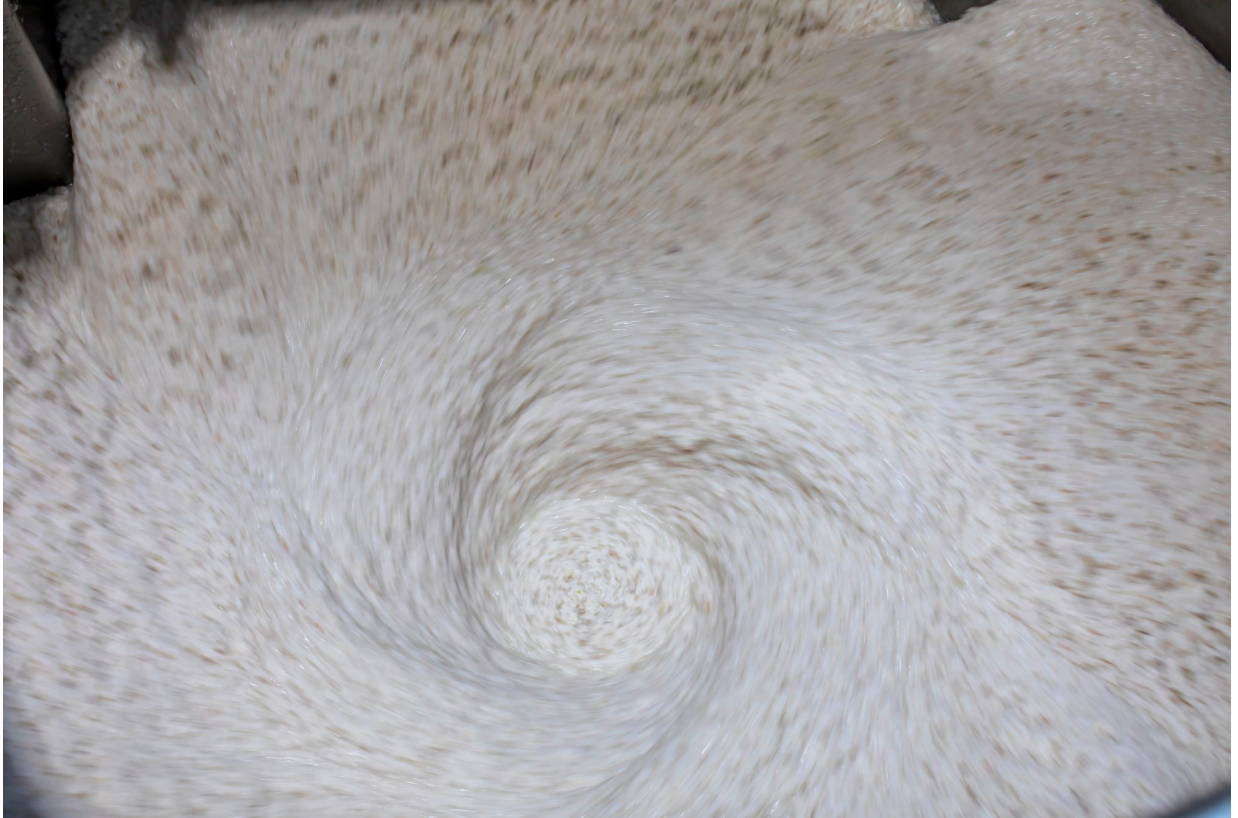
バルパーという大きなミキサーにパルプ（再生紙）とういろを入れて攪拌し、繊維をばらばらにほぐします。
