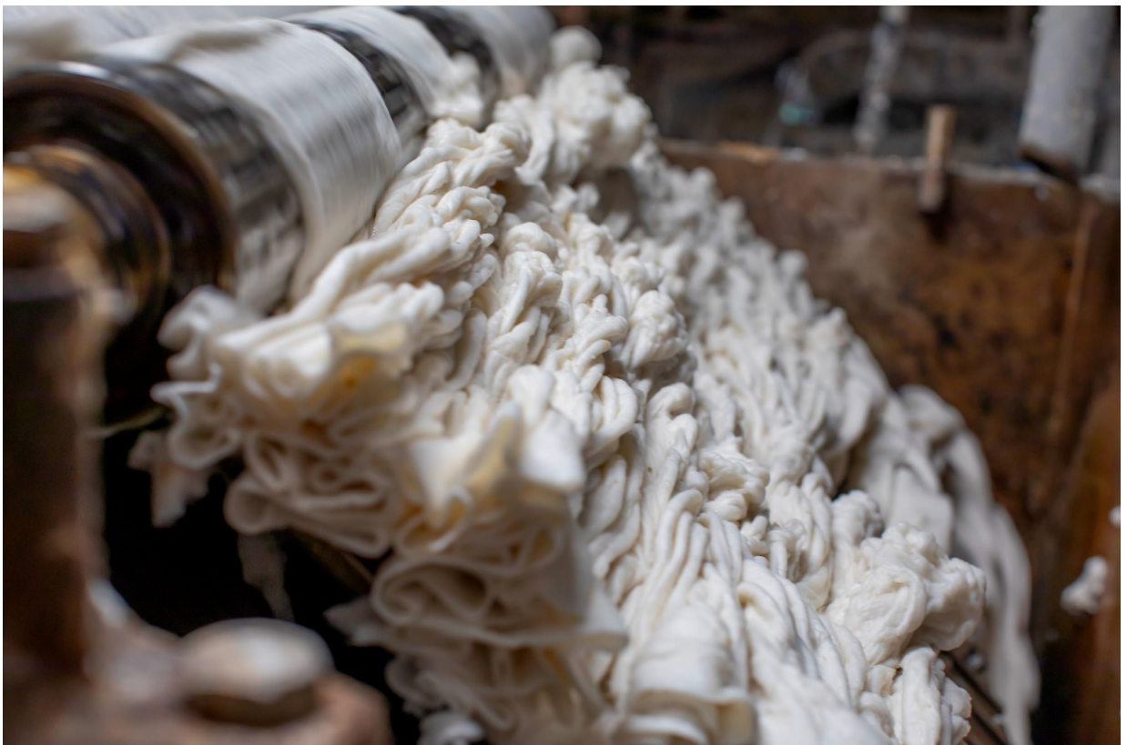
その繊維に水を加えて洗い、ゴミなどを除いたら、まんべんなく広げてシート状に。
